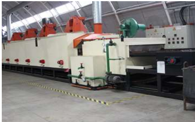
Unitate pentru tratarea termică a blank-urilor de inele de rulmenți – cuptor electric WD-HH-100x14
