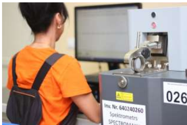
Spectrometru «SPECTROMAXx» (SPECTRO Analytical Instruments GmbH, Germania)
