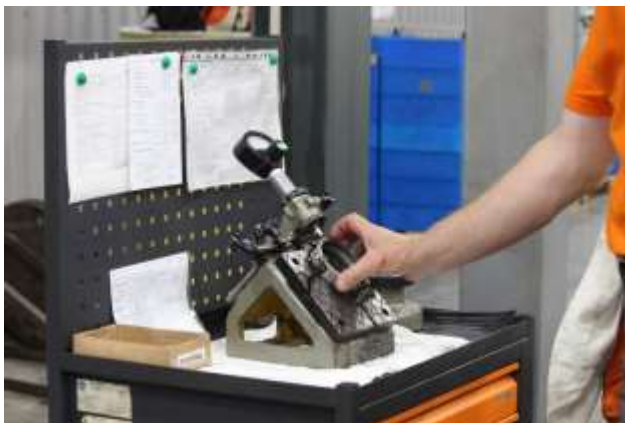
Controlul selectiv al inelelor în cadrul procesului de șlefuire
